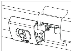
3.1 Защелкните шарнир в отверстие на нижней стороне рамы.
