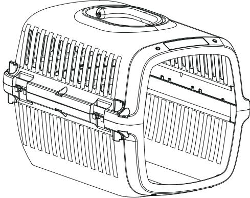
2. Слегка приподнимите верхнюю часть и вставьте нижние стержни двери в самые внешние отверстия нижней части. Опустите верхнюю часть вниз, одновременно вставляя верхние стержни двери в самые внешние отверстия верхней части.
