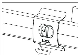
3.4 Сдвиньте блок защелки в направлении стрелки (см. рисунок)
